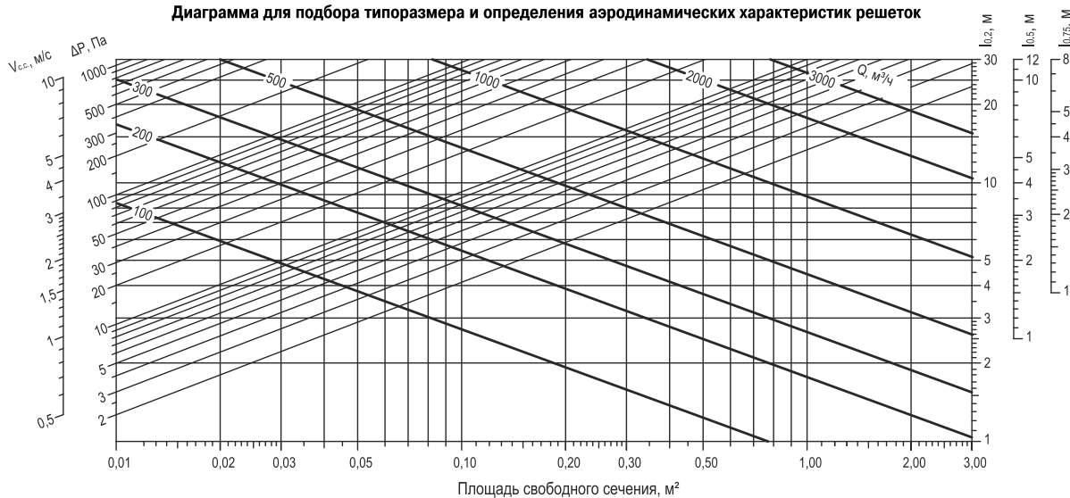
Диаграмма для подбора типоразмера и определения аэродинамических характеристик решеток
